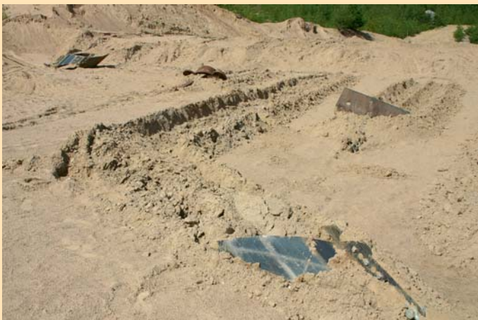
Sneddragning av Moorsafe ankare visar stabiliteten.
